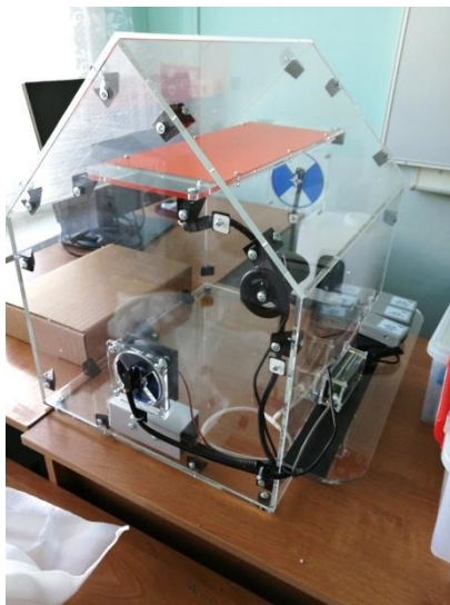
Настольная модель теплицы с датчиками окружающей среды
